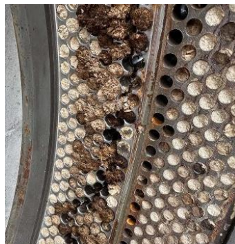
Gambar Kerusakan Rieng Dies
