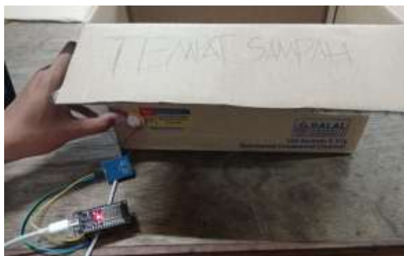
Gambar 1.3 Prototipe wadah kardus sebagai tempat sampah simulasi dengan perangkat keras
